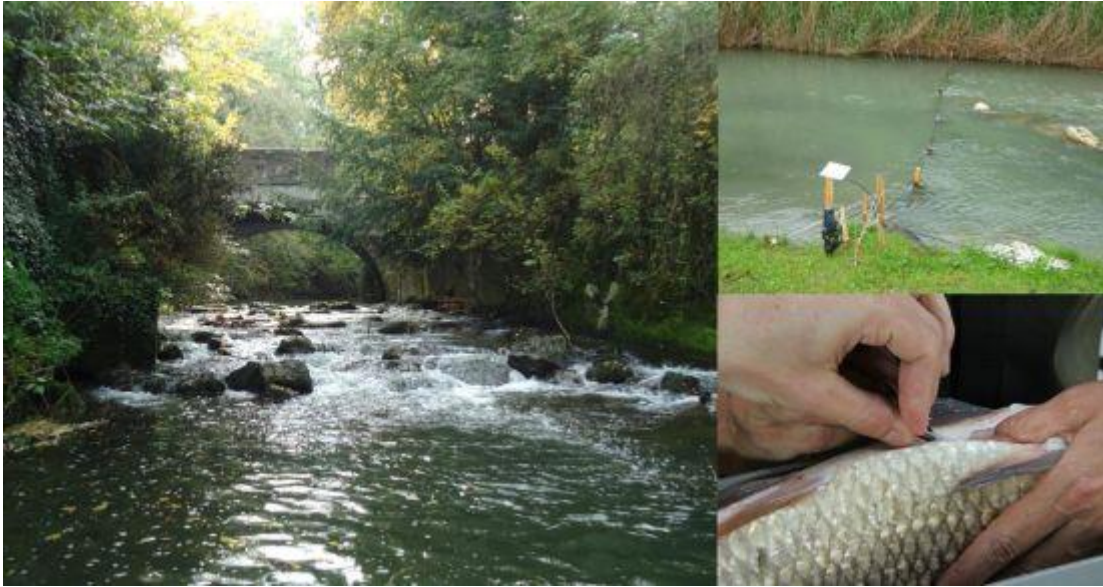
Abbildung 2: Eine der untersuchten Blockrampen an der Pfaffneren (links), eine Antenne (rechts oben), welche die Passage von mit Pit-Tags markierten Fischen (rechts unten) feststellt.
